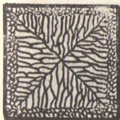
Рис. 10. Схема полной транскристаллизации слитка.
