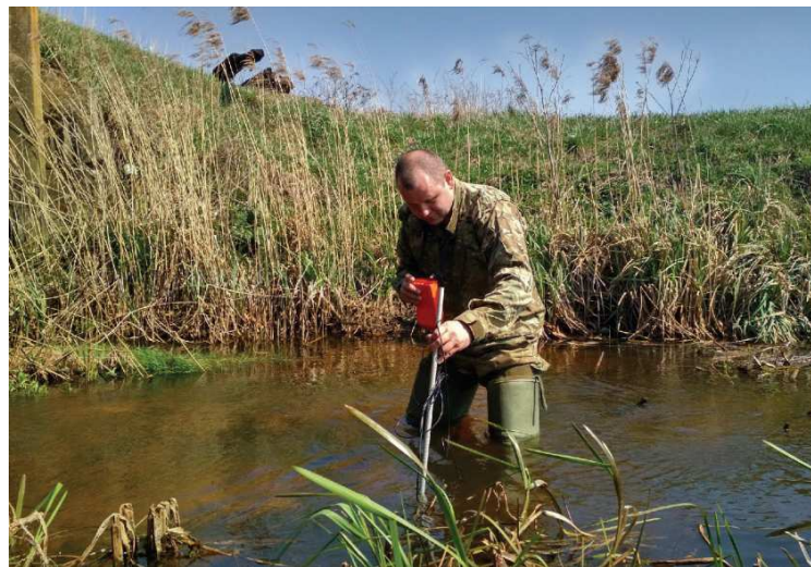
Рисунок 2 – Пример гидрометрических измерений поперечного сечения и скоростного режима водного объекта в створе выпуска сточных вод
