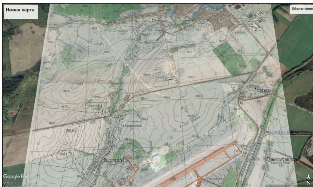
Рисунок 2 – Пример наложения картографических материалов съемки 1948 года на современную космосъемку
