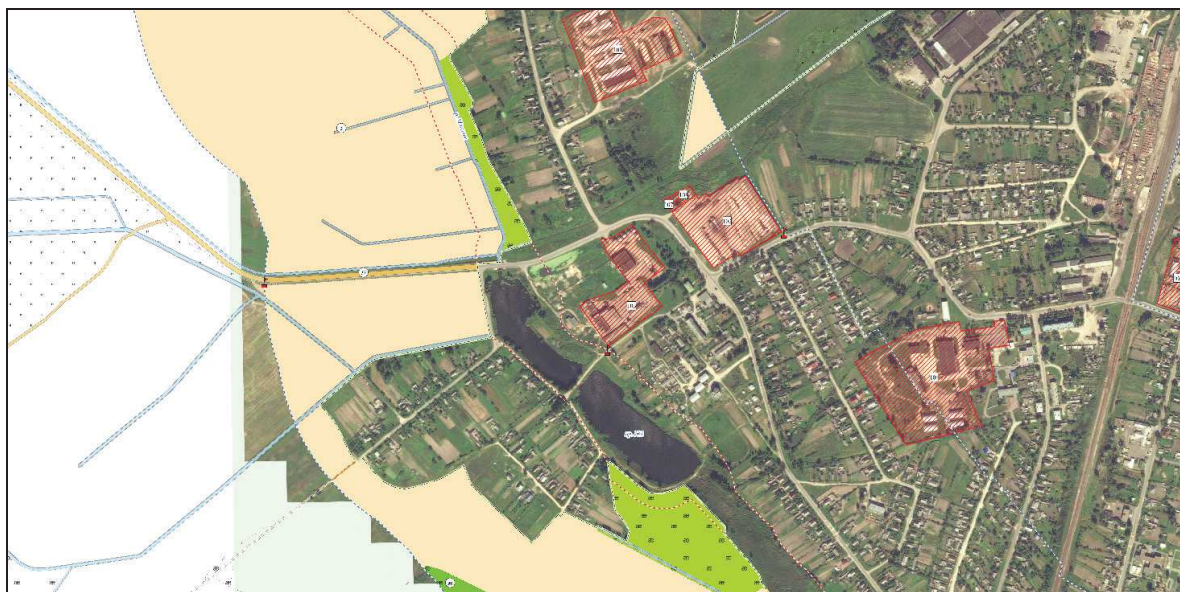
Рисунок 4 – Пример наложения современного космического снимка на ЗИС с нанесенными границами ВЗ и ПП, источниками загрязнения и информационными знаками
