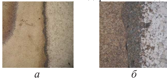
Рисунок 2 – Микроструктура сварного соединения после термической обработки: a – \times 100 ; б – \times 500
