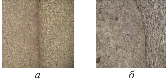
Рисунок 1 – Микроструктура сварного соединения без термической обработки: a – \times 100 ; б – \times 500
