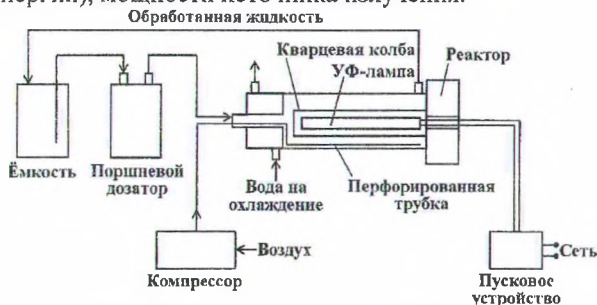
Рисунок 1 – Установка для обработки воды во взвешенном слое фотокатализатора
