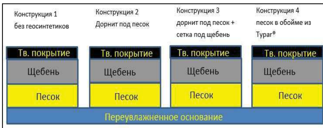
Рисунок 1 – Закладываемые опытные конструкции
