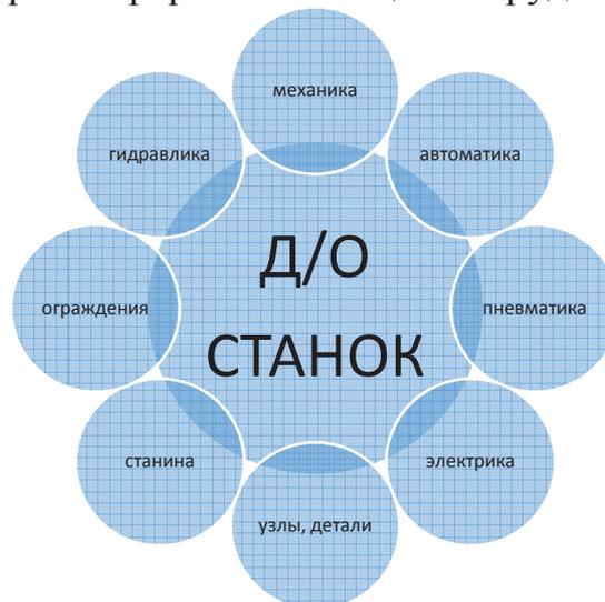
**Рисунок 1 – Элементы деревообрабатывающего станка**
