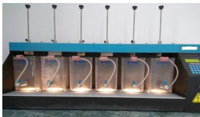
Рисунок – Флокулятор лабораторный программируемый
