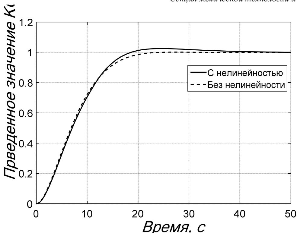
Рисунок 2 – Переходной процесс системы комбинированного управления с нелинейностью
