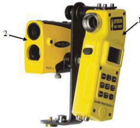
1 – дендрометр Criterion RD 1000; 2 – дальномер TruePulse 360
