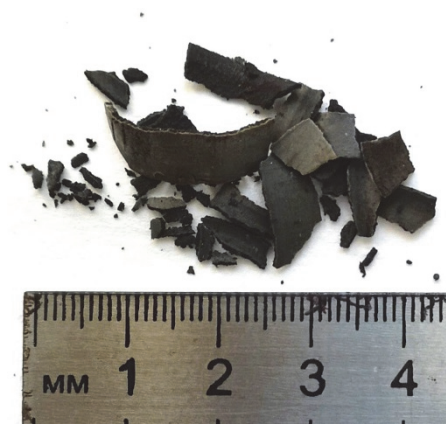
Карбонат кальция отобран с клапанной пары электроцентробежного насоса скважина 292 Речицкого месторождения
