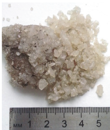
Хлорид натрия (галит) отобран с поверхности насосно-компрессорных труб скважина 11 Карташовского месторождения
