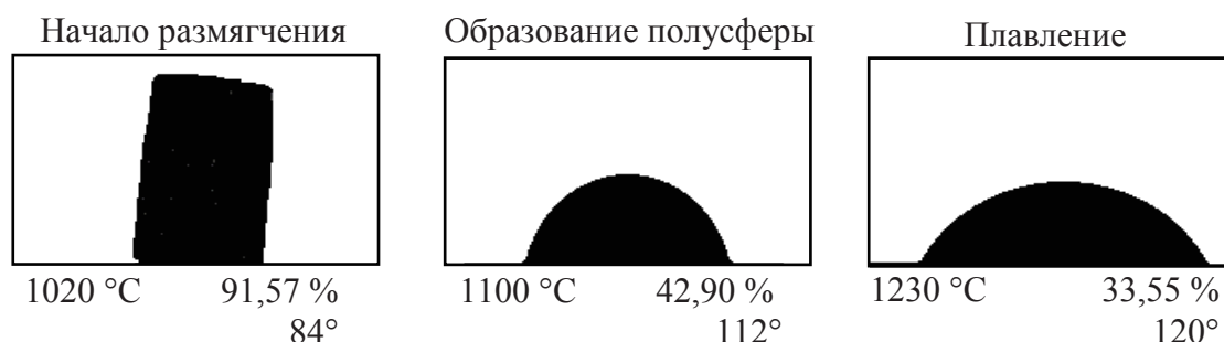
Рисунок 4 – Результаты определения плавкости и краевого угла смачивания глазури оптимального состава серии 2
