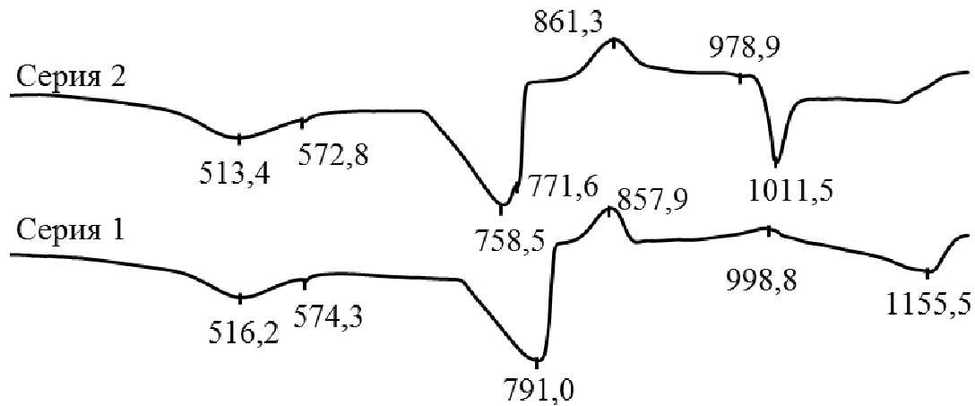
Рисунок 3 – Диаграммы дифференциально-сканирующей калориметрии глазурных шихт серий 1 и 2
