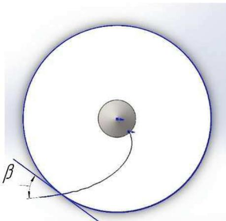
**Рисунок 6 – Угол в момент слета частицы с диска**
