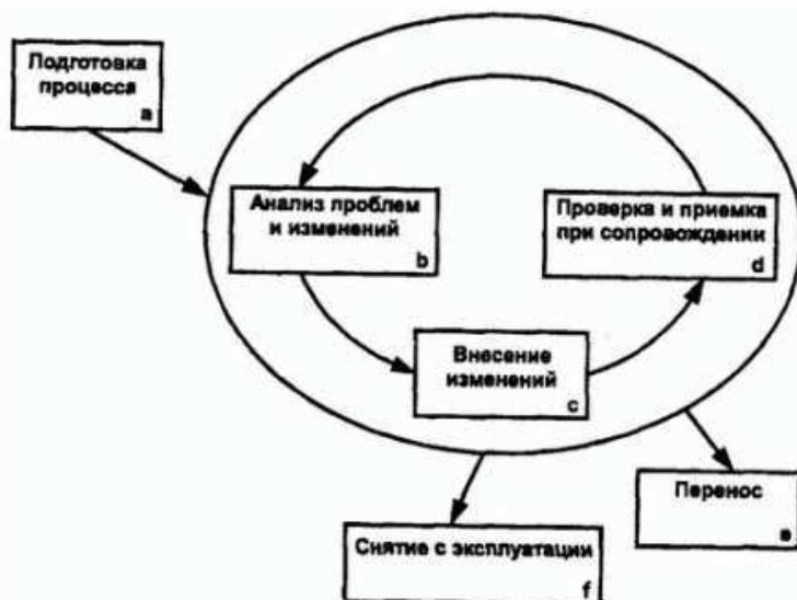
**Рисунок 1 – Схема процесса сопровождения программного средства**
