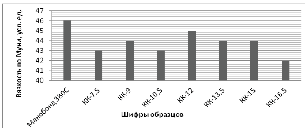
Рисунок – График вязкости резиновых смесей с опытными промоторами
