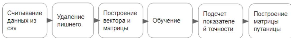
Рисунок 2 - Процесс работы ПС
