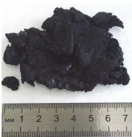
АСПО с поверхности штангового глубинного насоса скважина 58 Северо-Домановичского месторождения
