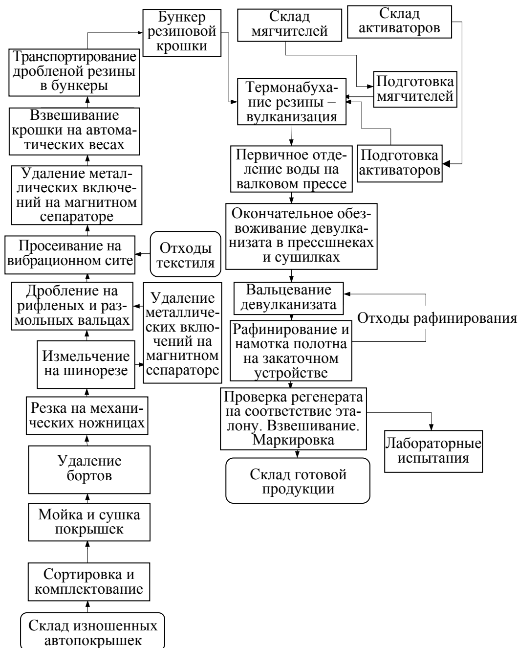
Рис. 3. Схема производства регенерата водонейтральным методом
