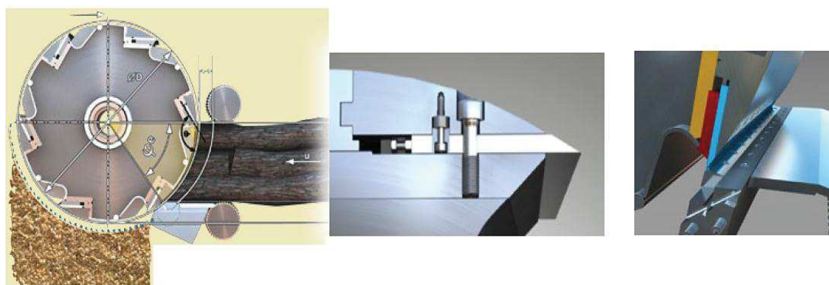
Рис. 2. Схема взаимодействия инструмента с обрабатываемым материалом
