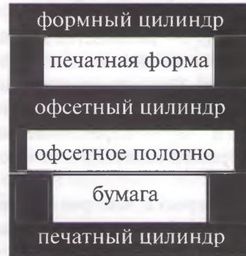
Рис. 1. Принципиальная схема переноса краски
