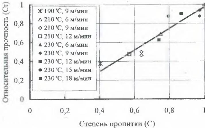
Следовательно, режимы пропитки играют решающую роль при назначении параметров on-line-намотки. Метод расчета степени пропитки роллинга расплавом полимера на основе кинетического уравнения (1) дает удовлетворительные результаты и может быть использован при оптимизации режимов пропитки при on-line-намотке.
