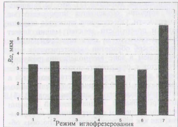
Рис. 1. Изменение шероховатости поверхности образцов стали 12XН3А при иглофрезеровании: (по оси абсцисс номера опытов в соответствии с таблицей)
