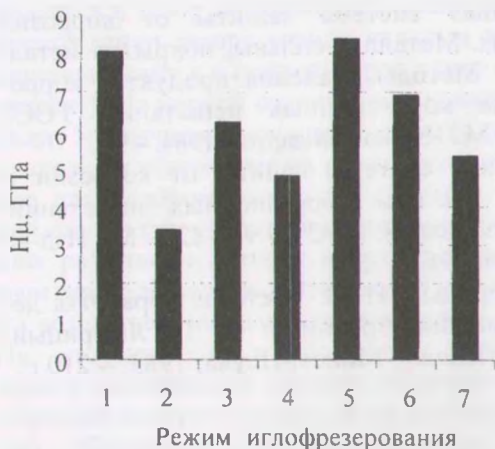
Рис. 3. Изменение микротвердости поверхности образцов стали 12ХН3А при иглофрезеровании (по оси абсцисс номера опытов в соответствии с табл. 1)
