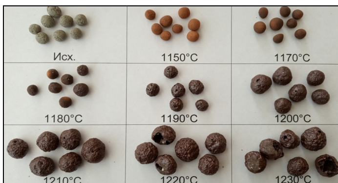
Рис. Динамика изменения агрегатного состояния сырцовых гранул на основе гранитоидной породы в процессе термообработки
