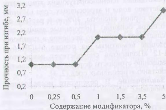
Рис. 3. Влияние концентрации «Полирита» на прочность при изгибе
