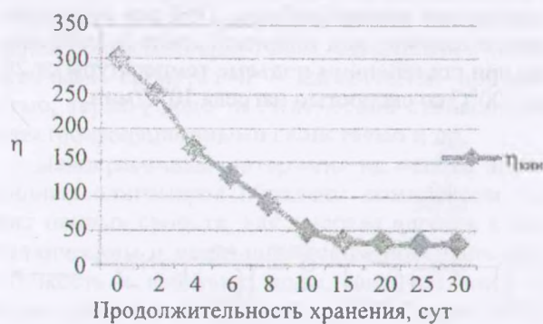
Изменение кинематической вязкости полиамидокислотных растворов в ДМФА в зависимости от продолжительности хранения при 20°C
