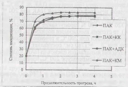
Рис. 1. Зависимость степени имидизации пленок от продолжительности прогрева при 200 °С и вида модификатора
