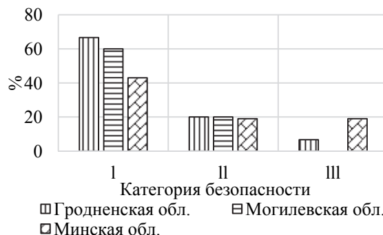
Рис. 7. Вероятность появления на низовом откосе грунтовых подпорных и ограждающих сооружений выходов фильтрационных вод
