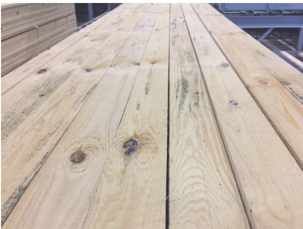
Рис. 3. Площадь поражения пиломатериалов более 15%
