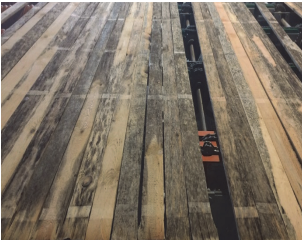
Рис. 2. Площадь поражения пиломатериалов более 50%
