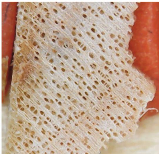
Рис. 3. Образец натуральной древесины ольхи
