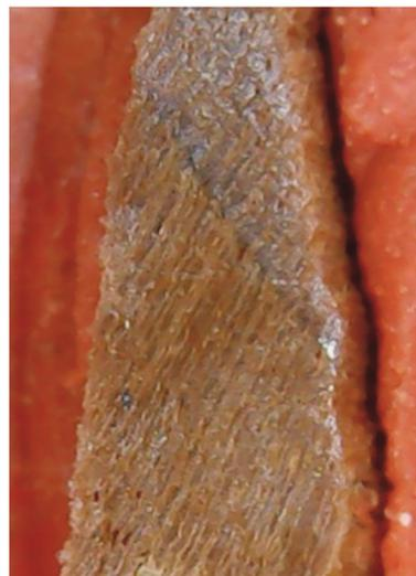
Рис. 4. Образец уплотненной древесины ольхи
