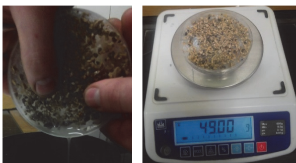
Рис. 5. Слив образовавшейся суспензии и взвешивание остатков
