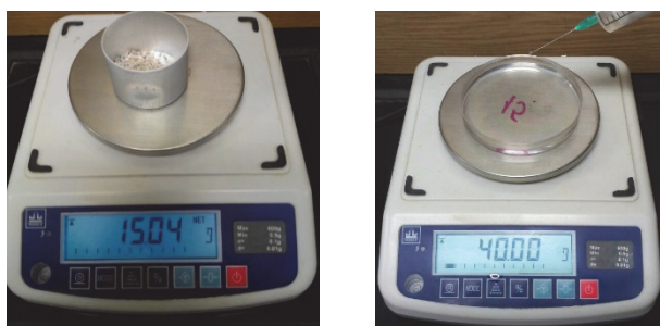
Рис. 3. Взвешивание противогололедного материала и дистиллированной воды
