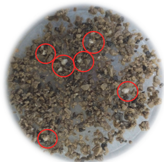
Рис. 7. Зерна реагента, не вступившие в реакцию через 1 ч нахождения состава в камере при концентрации реагента 10%
