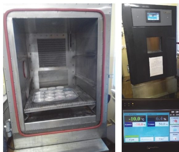
Рис. 6. Лабораторная климатическая камера «Термокон ТХВ-225»
