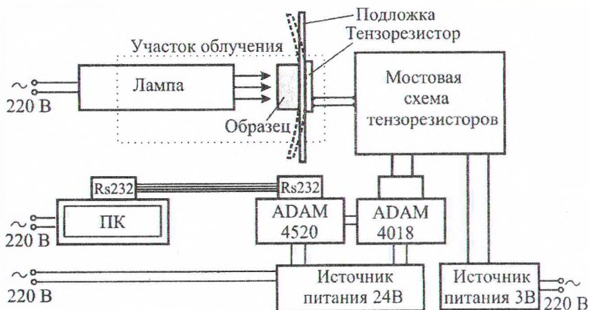
Рис. 3. Схема измерения усадочных деформаций
