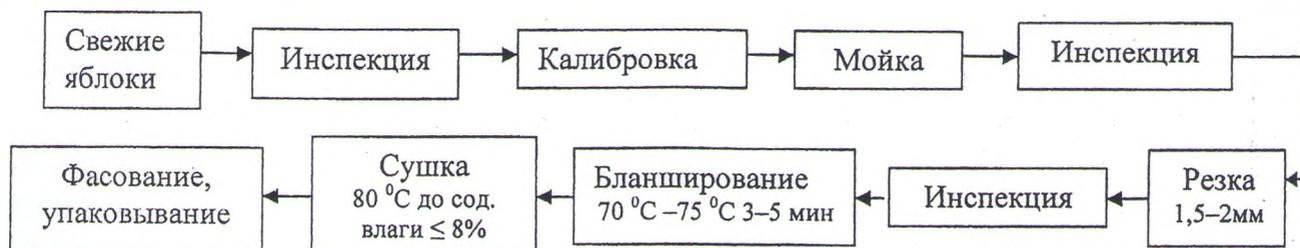
Рисунок 1 – Структурная схема процесса производства яблочных чипсов
