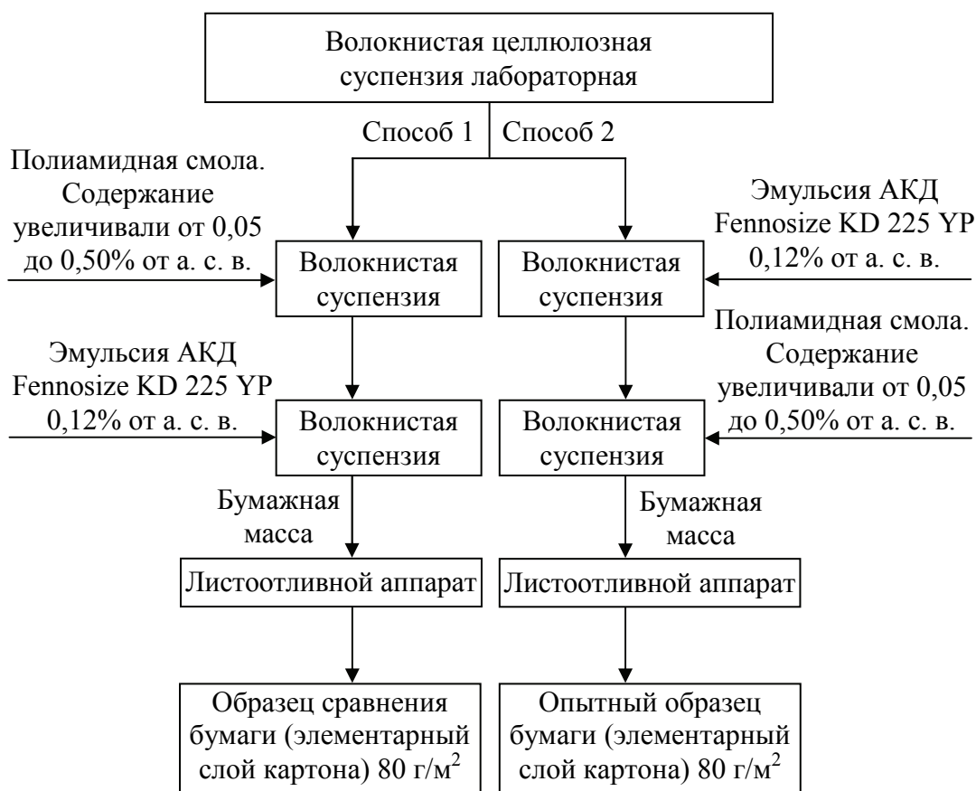
Рис. 2.28. Блок-схема получения образцов бумаги (элементарных слоев картона) с использованием полиамидной смолы и эмульсии АКД с разной последовательностью их введения в волокнистую суспензию
