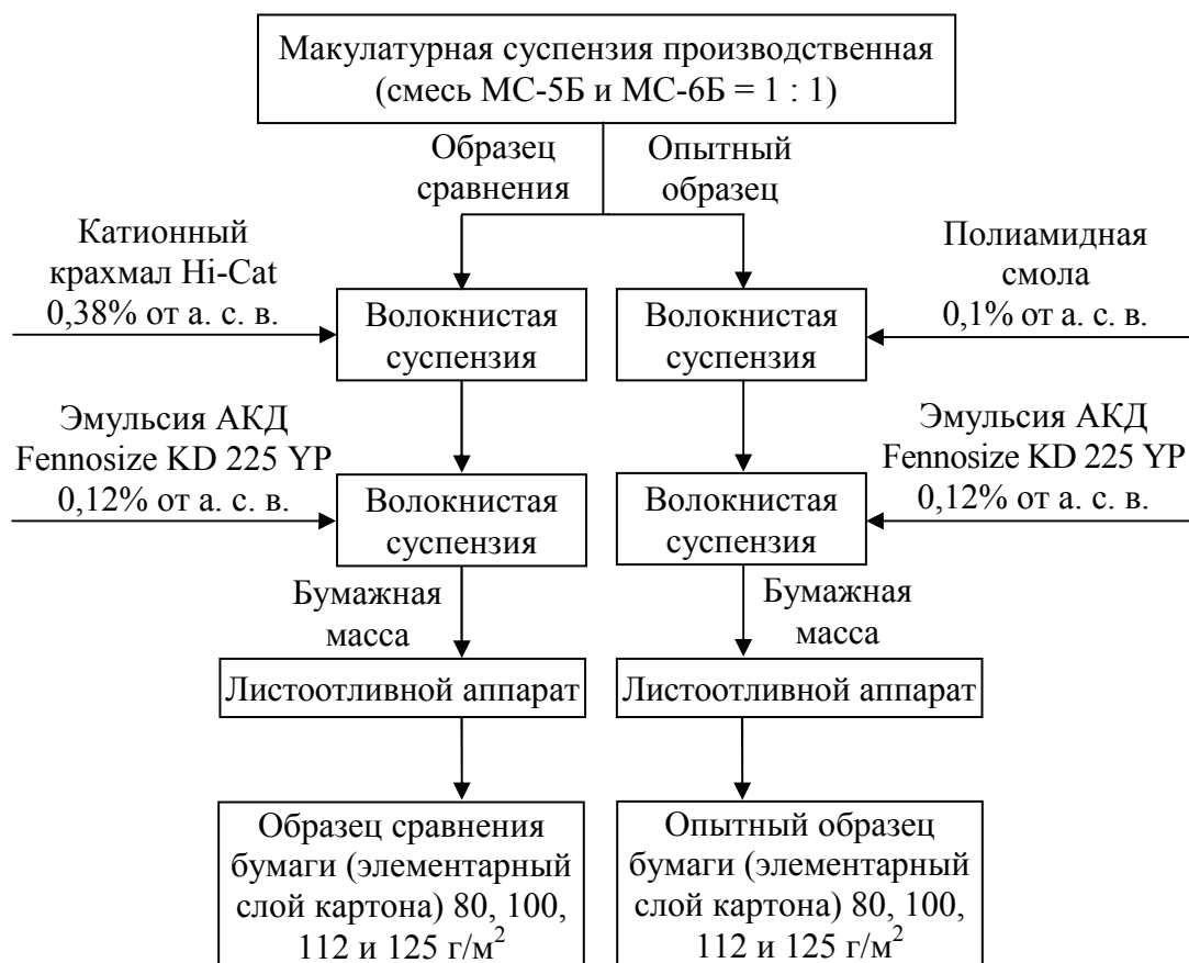
Рис. 2.30. Блок-схема получения образцов бумаги (элементарных слоев картона) с использованием полиамидной смолы, катионного крахмала и эмульсии АКД с разной последовательностью их введения в производственную макулатурную суспензию
