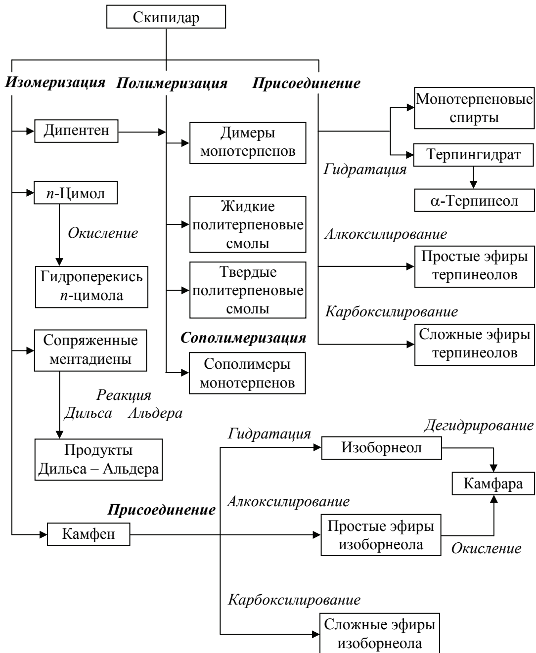
Рис. 1.3. Комплексная схема глубокой переработки скипидара
