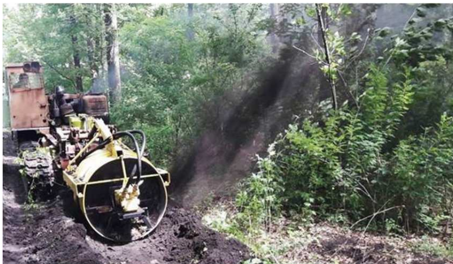
Рис. 2 – Процесс метания грунта лесопожарной грунтометательной машиной в агрегате с трактором ЛХТ-55
