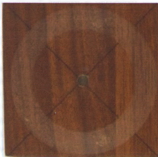
Рисунок 4 – Внешний вид образца после испытания по определению класса истираемости
