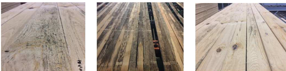
Рис. 1 – Различная степень поражения пиломатериалов
