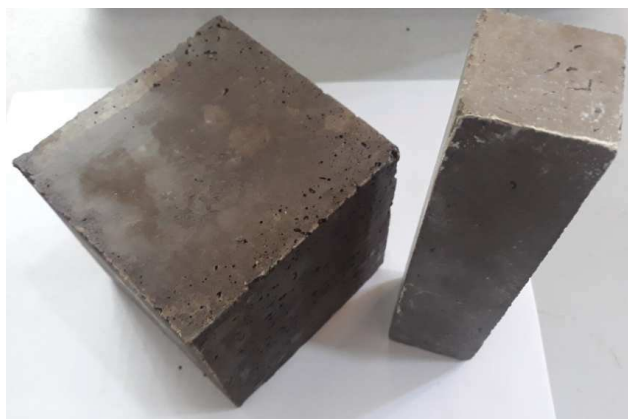
Рисунок 1 - Образцы из серного бетона
