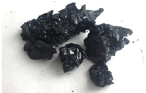
**Рисунок 1 - Внешний вид полученного пекоподобного продукта**
