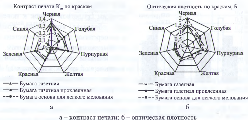
Рисунок 5 – Диаграммы изменения печатных свойств бумаги по краскам в зависимости от вида поверхностной обработки
