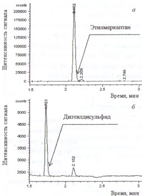
Рисунок 4 – Ферментативное окисление этилмеркаптана в диэтилдисульфид
