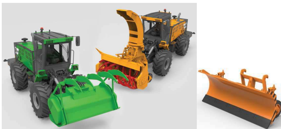
Рисунок – Универсальное лесное шасси с технологическим оборудованием для содержания лесных дорог
