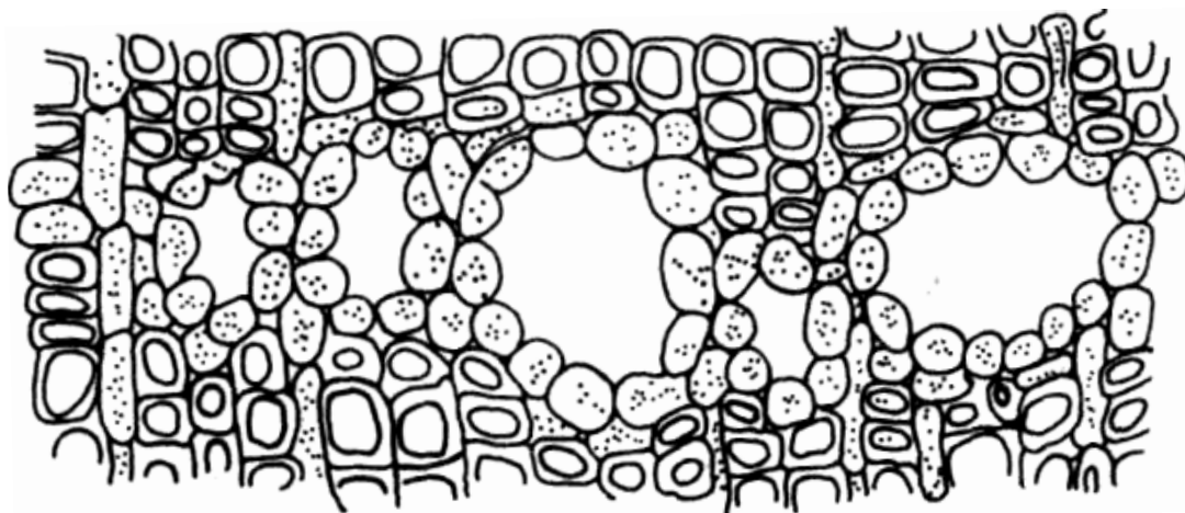
Рис. 1.2. Вертикальные травматические ходы в древесине ели европейской в поперечном разрезе
