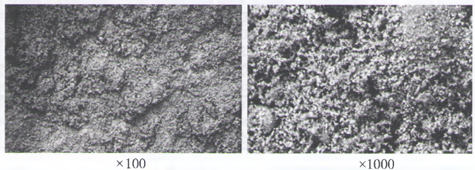
Рис. 2. Электронно-микроскопические снимки с поверхности частиц пыли ПГУ-1,2
