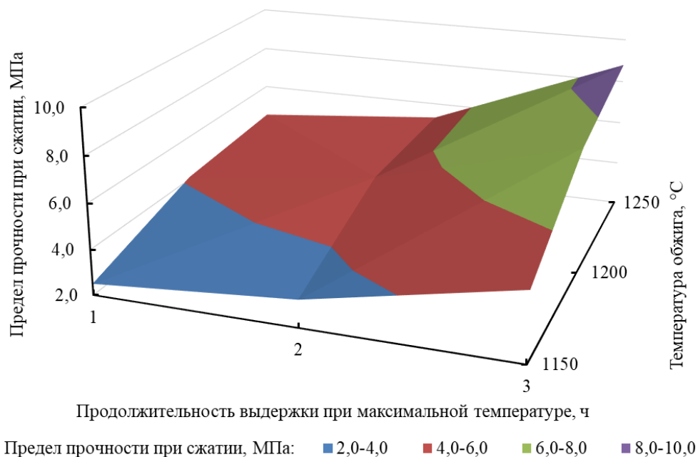
Рисунок 2 - Зависимость прочности образцов от температуры обжига и гранулометрического состава кварцевого стекла
