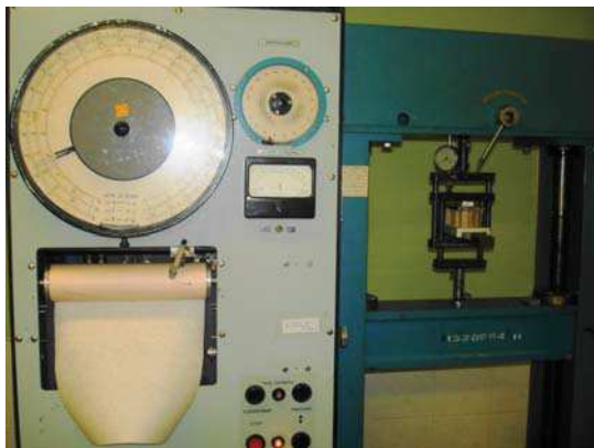
Рис. 1. Схема испытания бумажного сотового наполнителя на сжатие
