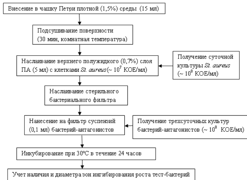
Рис. 3. Схема разработанного диффузионного метода определения антагонистических свойств с использованием мембранных фильтров
