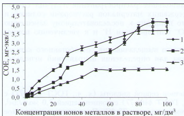
Рисунок 2 – Изотермы сорбции ионов металлов ОКК после выщелачивания раствором серной кислоты. 1 – железо; 2 – медь; 3 – цинк.
