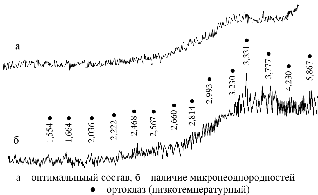
Рисунок 2 – Дифрактограммы прозрачных глазурных покрытий
