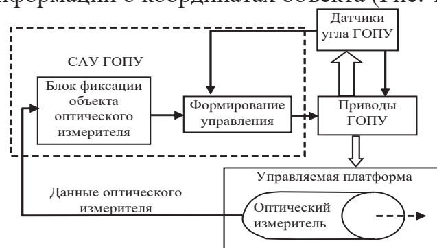
Рисунок 1 - Структура ГОПУ с основными обратными связями
