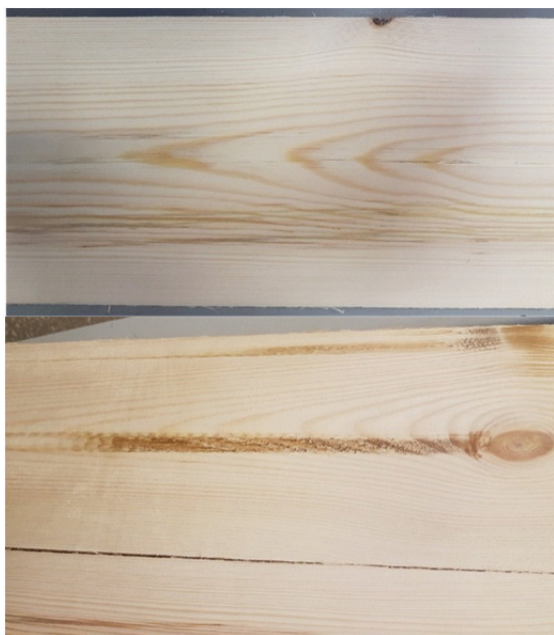
Рис. 4. Дефекты на поверхности шлифования в виде прижогов
