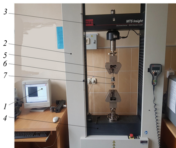
Рис. 5. Разрывная машина MTS InsightTM: 1 – персональный компьютер; 2 – рама; 3 – подвижная балка; 4 – неподвижная балка; 5 – зажимы; 6 – крепление образца; 7 – исследуемый образец
